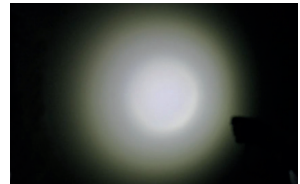
Fokusring hereingedreht – breite Ausleuchtung
