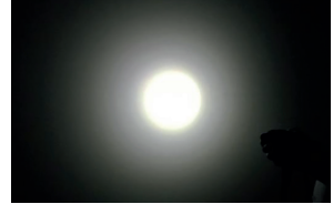
Fokusring herausgedreht – fokussiertes Licht
