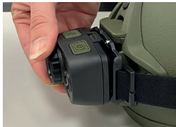
Fokusring hereingedreht – breite Ausleuchtung
