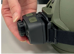
Fokusring herausgedreht – fokussiertes Licht
